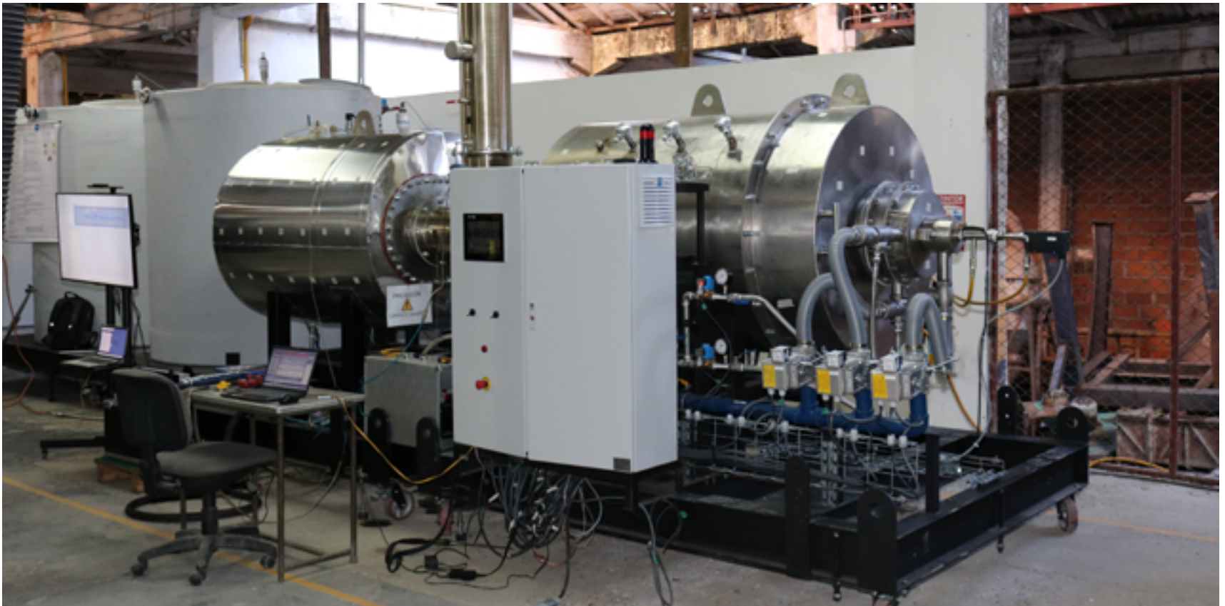
Esta planta de oxidación sin llama se instaló inicialmente, como proyecto piloto, en un espacio que tiene la Universidad de Antioquia en el barrio El Chagualo, de Medellín. Foto: Facultad de Ingeniería UdeA.
